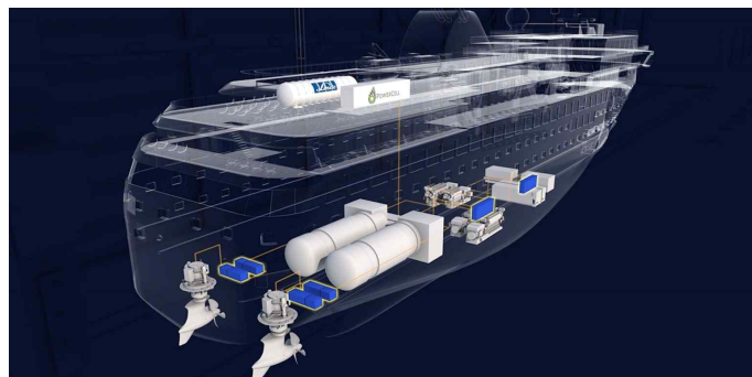
<그림 31> Havyard에서 개발하는 대형선박용 수소연료전지 추진시스템(노르웨이)
